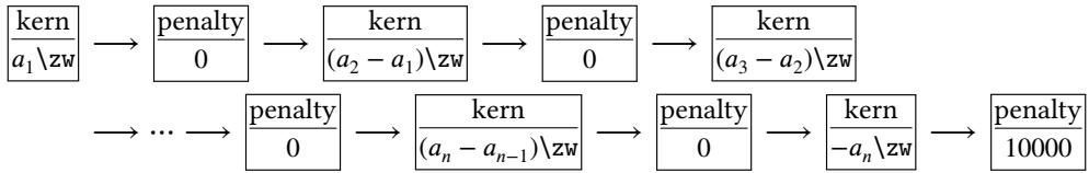
$n$  個あるペナルティの箇所が改行可能箇所である。いずれかで改行された場合は、その前にあるカーン ( $n$  箇所のうちどこで改行しても、合計の長さは  $a_i$  の形) は行末に残るが、後ろのペナルティ・カーンは除去される。なお、 $a_1 = 0$  のときは最初の幅が  $a_1\zw$  のカーンは不要なので挿入されず、さらにかつ  $n = 1$  であった場合は後ろのペナルティも挿入されない。
