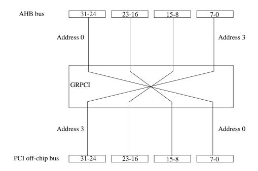
Figure 227. GRPCI byte twisting
