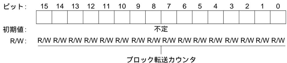
ブロック転送モードでは、ETCRAHは8ビットのブロックサイズカウンタとして機能し、ETCRALはブロックサイズを保持します。ETCRAHは、1バイトまたは1ワードの転送を行うたびに1だけデクリメントされ、H'00になるとETCRALの内容が転送されます。したがって、ETCRAHとETCRALにブロックサイズを初期設定することにより、任意のバイト数またはワード数のブロック転送を繰り返し行うことができます。
