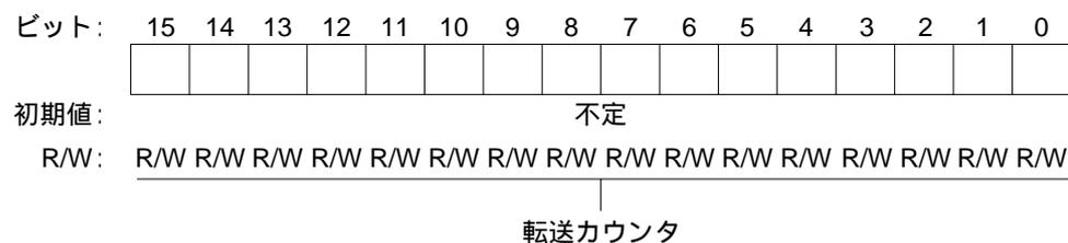
I/O モードとアイドルモードでは、ETCR は 16 ビットの転送カウンタとして機能します。1 回の転送を行うたびに、1 だけデクリメントされカウンタ値が H'0000 になると転送を終了します。
