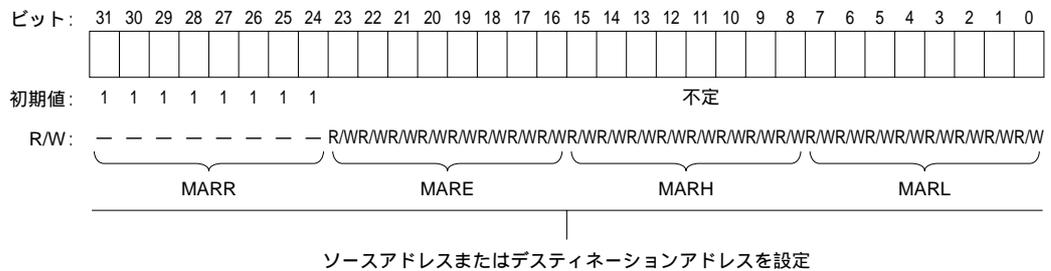
MAR は 1 回のバイト転送またはワード転送のたびにインクリメント/デクリメントされ、ソースまたはデスティネーションのメモリアドレスを自動的に更新することができます。詳細は、「7.3.4 データトランスファコントロールレジスタ (DTCR)」を参照してください。
