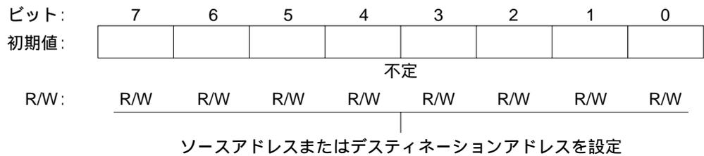
IOAR がソースアドレスレジスタとして機能するか、デスティネーションアドレスレジスタとして機能するかは、起動要因によって自動的に決定されます。起動要因が SCI チャネル 0 の受信完了割り込み、および A/D 変換器の変換終了割り込みの場合はソースアドレスレジスタとして、それ以外の場合にはデスティネーションアドレスレジスタとして機能します。
